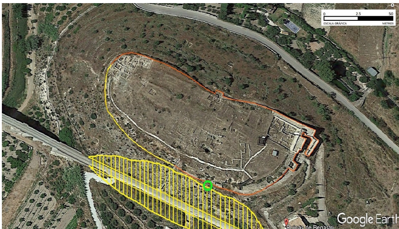
Figura 1. Foto aérea de Google Earth del yacimiento. Perímetro exterior de la muralla marcado en línea roja. Rayada en amarillo se ha indicado el área del desmante excavado por la obra de la antigua vía férrea, y en línea amarilla el tramo de perímetro de muralla desmantelada en dicha obra para reutilizar los sillares en la cimentación del puente.
